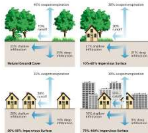
Figure 3.3 : Distribution de l'eau de pluie selon les milieux et la relation entre les surfaces imperméabilisées et le ruissellement Source : FISRWG, 1998 :3-23
